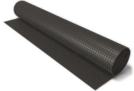
该材料重量轻，安装方便，具有较高的强度性能。对化学品、霉菌、细菌、植物根系及紫外线有较强的抵抗力。材料的顶部表面覆盖着 8 毫米高和 10 毫米直径的锥形螺柱。
